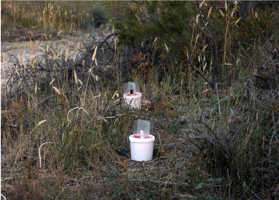
Рис. 6. Светоловушки, оборудованные источниками УФ-излучения 8 Вт разного свечения, на границе светового пятна основной ловушки.
