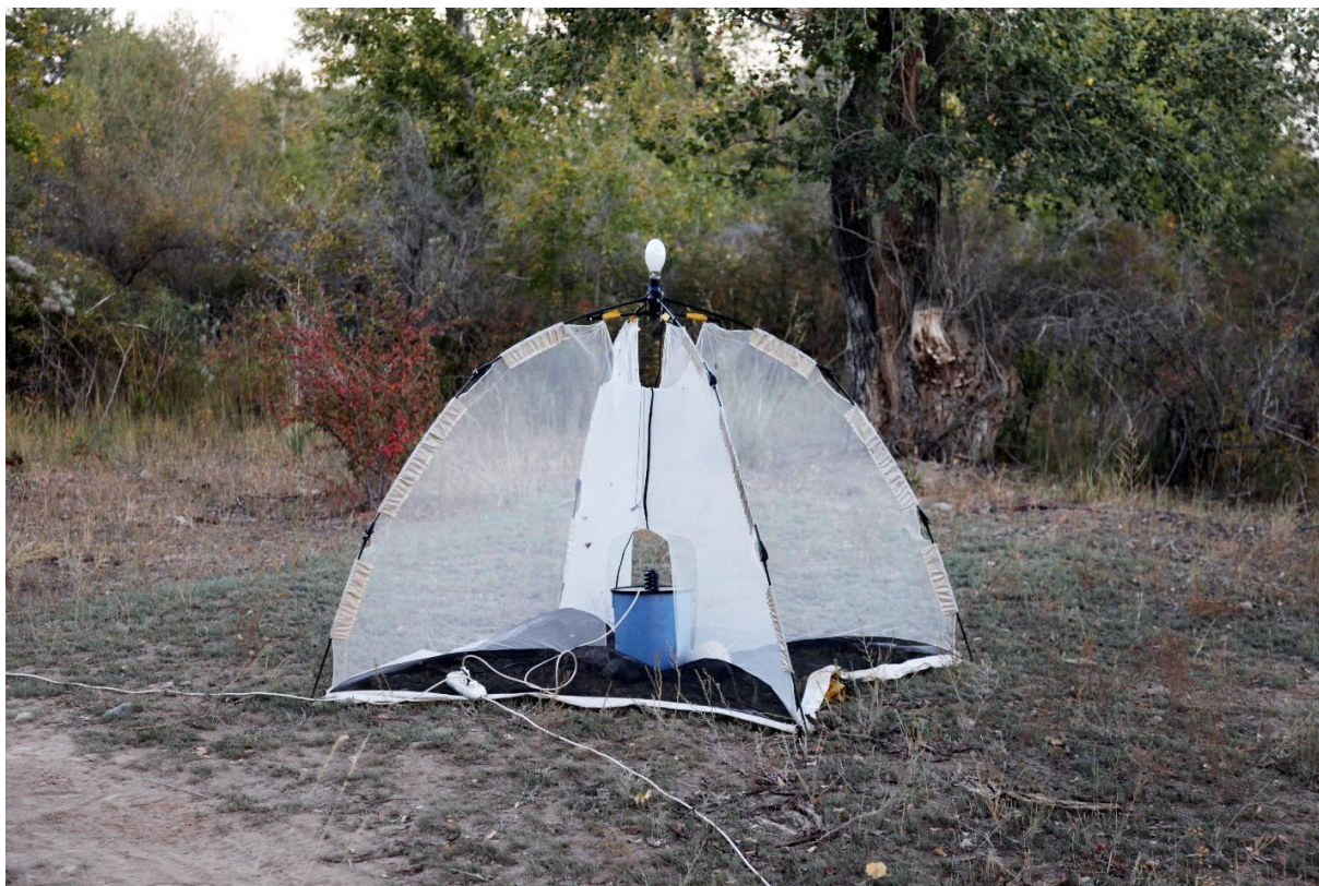
Рис. 5. Светоловушка, оборудованная источником УФ-излучения 160 Вт Fig. 5. Light trap equipped by an UV-source of 160 W
